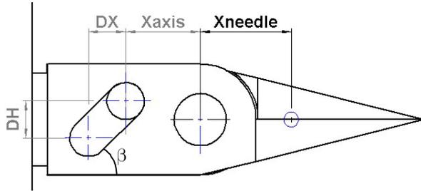
**Figure 6.** Gripper jaws parameters
